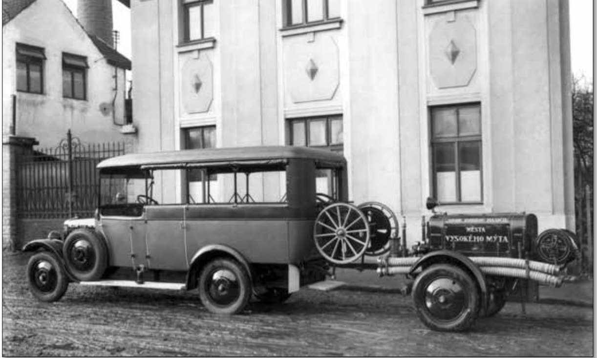
Dopravní automobil Škoda 125 s motorovou stříkačkou firmy Stratílek
